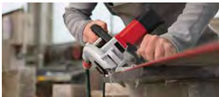
Stufenlose Winkeleinstellung für Gehrungsschnitte von 0-45°
